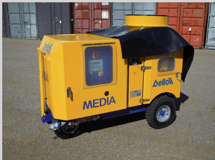
**Macchina per la proiezione di calcestruzzi per via secca e umida e per il trasporto pneumatico di ghiaietto**
