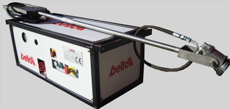
Die Pumpe BELLEX 312E wurde für das Versetzen von Reibrohrankern BELLEX Typ 120, 160, 200 und 240 konstruiert.
